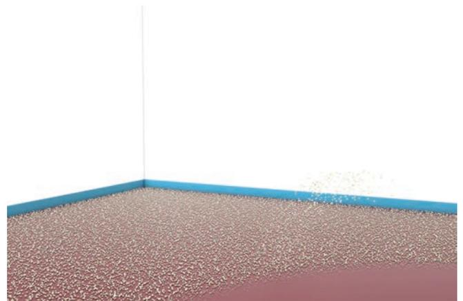
3.2.2. Einstreuung des Quarzsandes in die noch frische Bodenverlaufsmasse bzw. Rollbeschichtung
